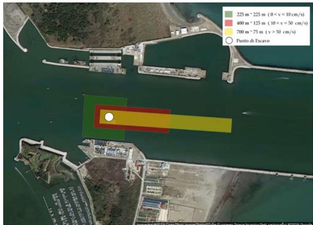
5. Esempio di forme dell'A.I.T. in funzione della velocità della corrente “v”, alla bocca di porto di Chioggia.
