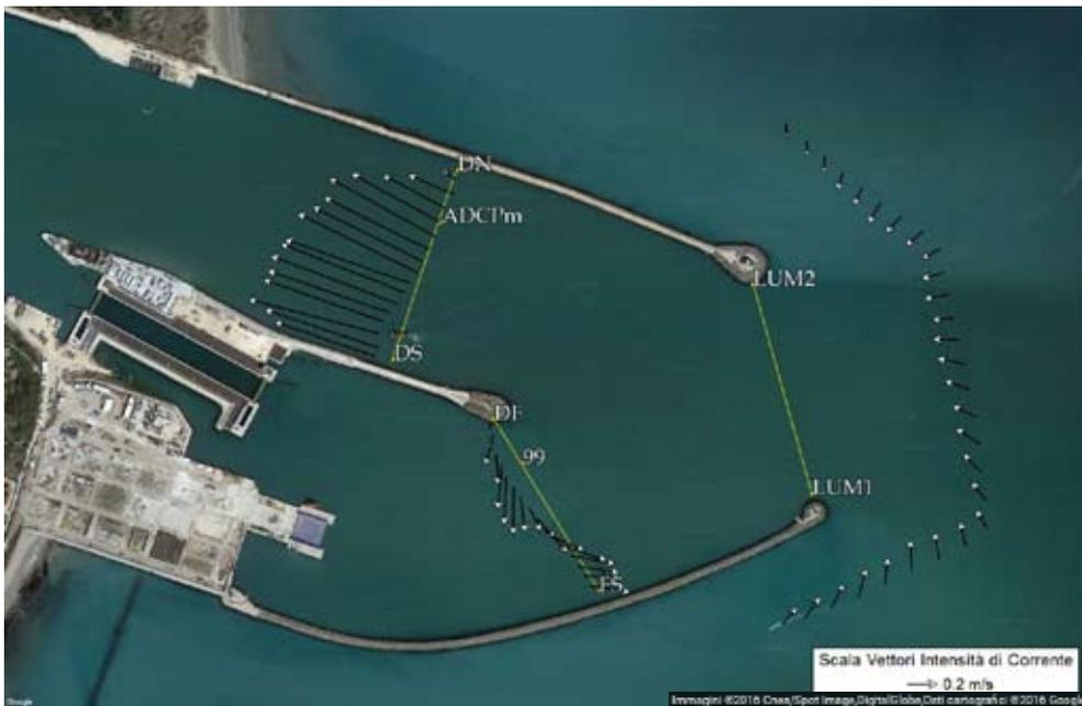
18. Configurazione del campo di corrente, come velocità media sulla verticale e direzione (evidenziate con vettori proporzionali all'intensità), presso la bocca di porto di Malamocco il giorno 4 ottobre 2013, con marea crescente. È evidente la struttura vorticoso all'interno del bacino di evoluzione della conca di navigazione. Dati mappa ©2016 Google.
