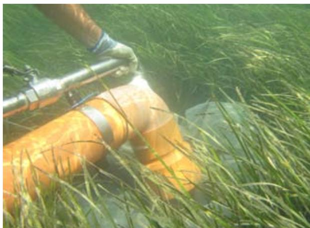
2. Raccolta dei campioni mediante sorbona idraulica.
