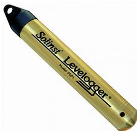
Levelogger® Solinst per la misura e la registrazione automatica dei livelli di falda.
