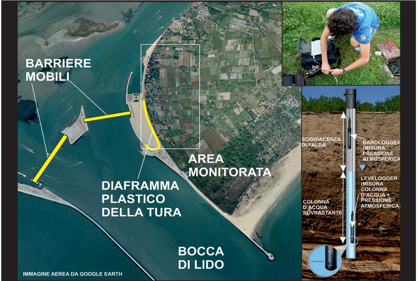
La costruzione del sistema MOSE ha richiesto la realizzazione di tre porti rifugio alle bocche di porto di Lido, Malamocco e Chioggia. Due di queste strutture, alla bocca di Lido – lato nord (Punta Sabbioni) ed alla bocca di Chioggia – lato nord (Ca' Roman), sono state inoltre usate come spazi di prefabbricazione delle barriere mobili. Questa soluzione ha permesso di evitare l'utilizzo di vaste aree sulla terraferma che avrebbe
