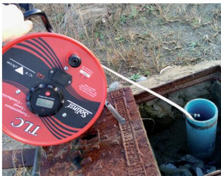
Sonda multiparametrica TLC107 Solinst, utilizzata per la misurazione dei profili di conducibilità elettrica specifica dell'acqua di falda.
