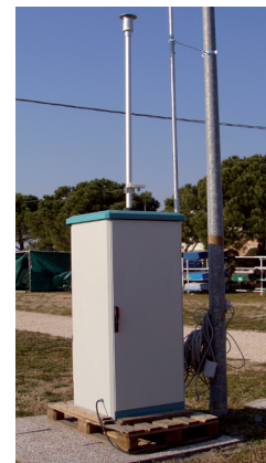
Campionatore automatico sequenziale di PM 10 (a destra). "Giorno-tipo" nel periodo dicembre 2004-maggio 2013 (sopra) per le concentrazioni di PM 10 e velocità del vento.
