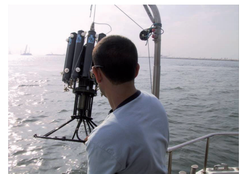
Bocca di porto di Chioggia: individuazione della AIT con punto di escavo o rilascio pietrame e valutazione della intensità e direzione di corrente. A maggior intensità di corrente corrisponde una maggior allungamento della AIT. In giallo un transecto per lo studio della propagazione del pennacchio di torbida. In basso: sistema per il prelievo di campioni d'acqua (Rosette®) e di acquisizione dei principali parametri idrologici (sonda multiparametrica).
