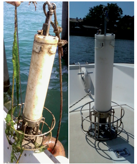
Sonda della stazione LTP, in bocca di Lido, prima (a sinistra) e dopo la pulizia (a destra) (18/07/2013).
