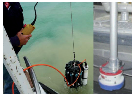
Il sistema di misura dei parametri idrologici, costituito da campionario a rosette e sonda CTD (a sinistra), ed il profilatore acustico Doppler (ADCP, a destra), utilizzato per la misura di velocità e direzione della corrente lungo il profilo verticale.
