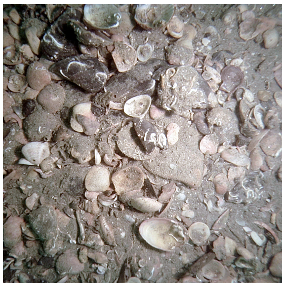
I materiali che ricoprono parte dei fondali della bocca di porto di Chioggia. Il detrito grossolano, in prevalenza gusci di bivalvi, condiziona il trasporto dei sedimenti e viene studiato con immagini subacquee e campionamenti per la caratterizzazione dei materiali.
