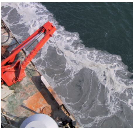
La draga idrorefluente a sfioro "Astra", ripresa dall'alto col braccio di scavo immerso dal fianco dell'imbarcazione, durante una fase di lavoro alla bocca di porto di Lido. A sinistra sono riportate le sezioni trasversali della nube di materiale sospeso a distanza crescente dal punto di scavo. Le differenti colorazioni lungo la sezione corrispondono a diversi quantitativi di materiale solido in sospensione (Rosso: maggiori concentrazioni, Blu: minori concentrazioni).
