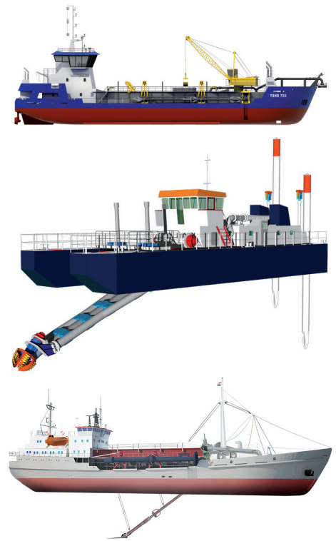
Le principali tipologie mezzi di dragaggio impiegate in laguna di Venezia durante la realizzazione delle opere mobili per la difesa dalle acque alte. Dall'alto: draga a benna (clamshell), draga idrorefluente (suction dredger), draga idrorefluente a sfioro (trailing suction hopper dredger).
